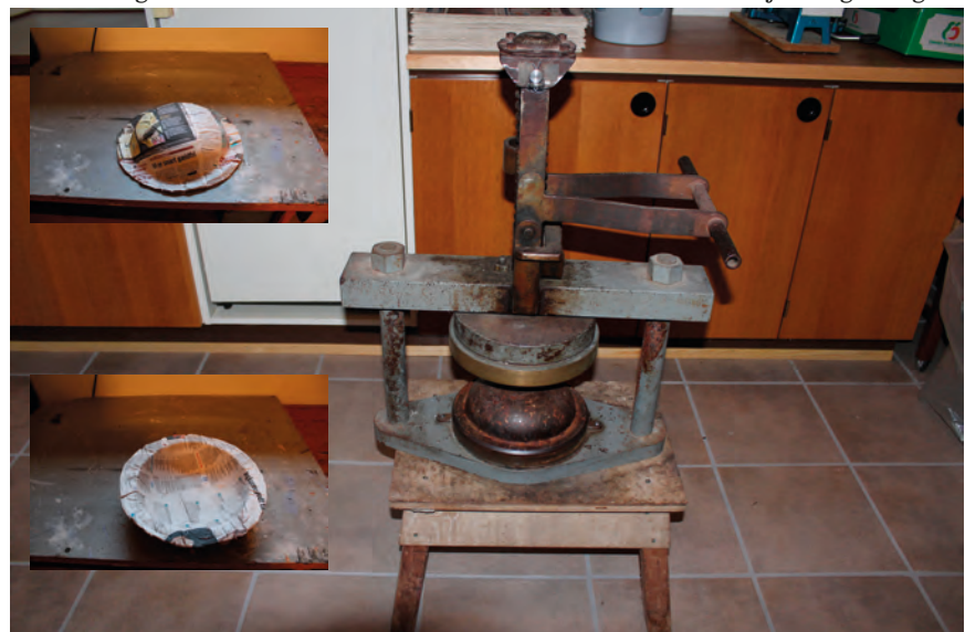
En maskine til at fremstille egne redemåtter fremstillet af tapetklister og aviser (en smart sag)
